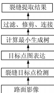
图4 路面裂缝检测流程图
